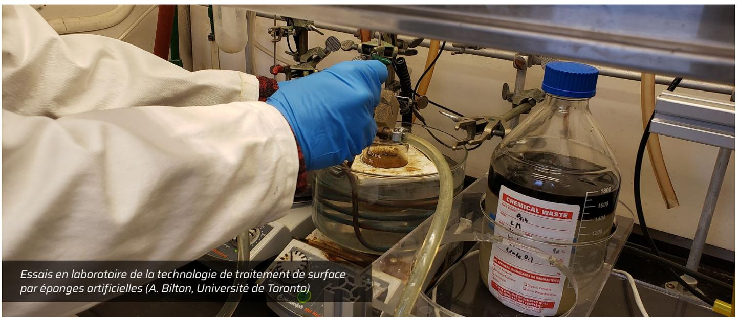
Essais en laboratoire de la technologie de traitement de surface par éponges artificielles (A. Bilton, Université de Toronto)
