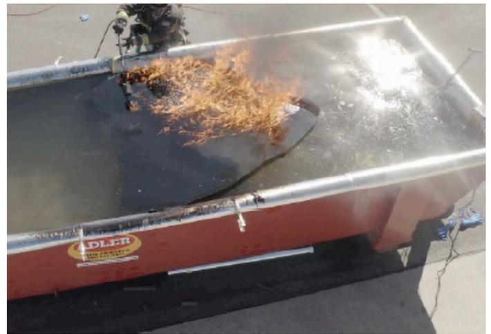
*Combustion sur place avec barrage simulé (P. Panetta & R. Byrne, Applied Research Associates)*
