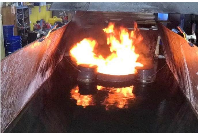
*Test de combustion sur place du pétrole brut en laboratoire (D. Cooper, SL Ross)*
